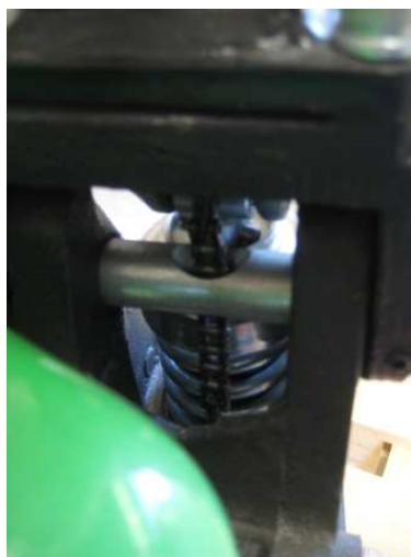
Figure.4 Une installation correcte de la chaîne externe du timon à travers le trou de passage situé sur le cylindre.
