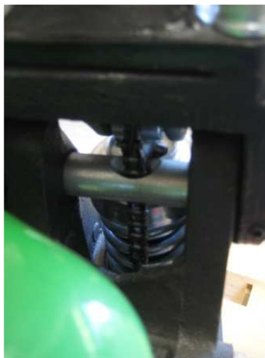
Figura.4 Corretta installazione della catena esterna del timone passante all'interno del foro situato nel cilindretto.
