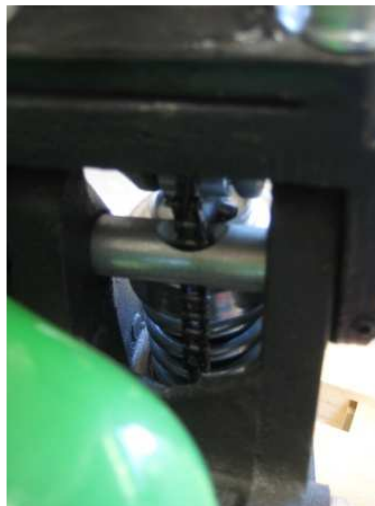
Bild.4 Korrekte Installation der äußeren Kette der Deichsel in das Innere des Zylinderbohrlochs.
