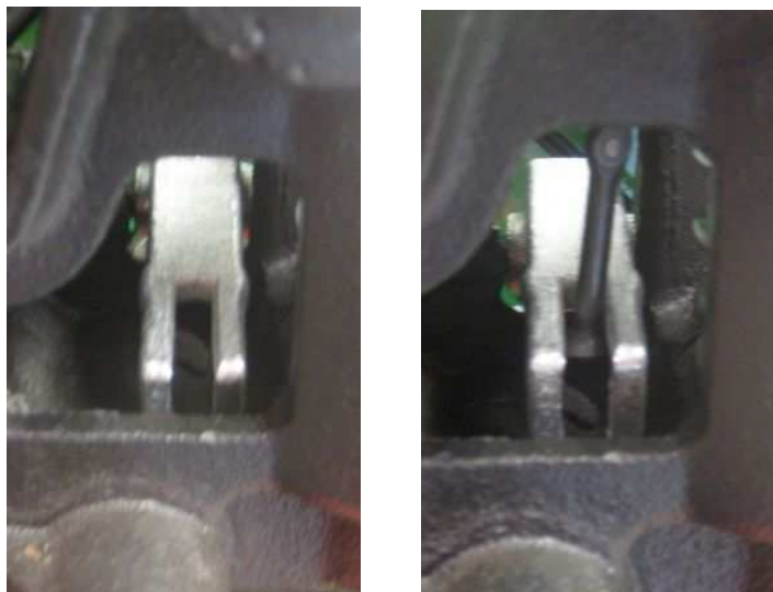
Figure.5 Un bon raccordement entre le crochet de la chaîne externe du timonier et la fourche de tirage.
